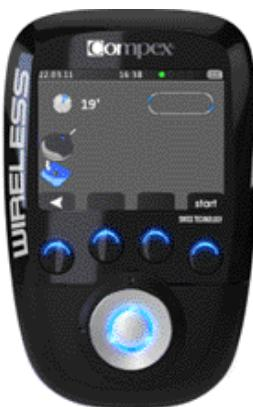
Daljinski upravljač prikazuje simbol elektrode i odspojeni modul na kanalu na kojem je problem detektiran (u ovom primjeru kanal 1).
